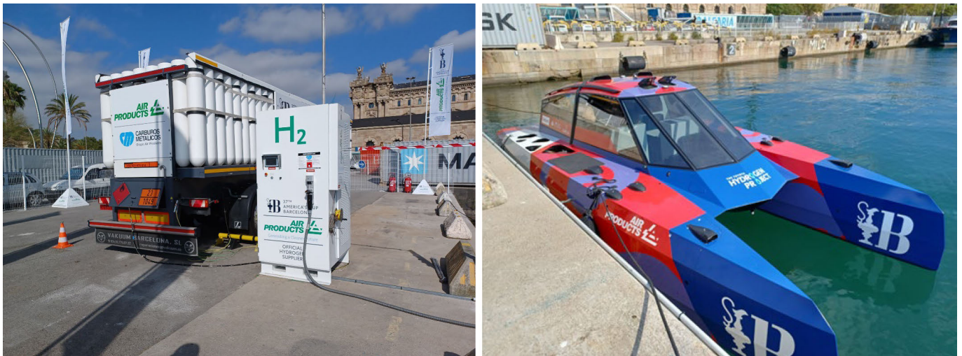
Suministro de hidrógeno en la 1ª fase en muelle Drassanes (izquierda). Embarcación propulsado por hidrógeno en la 1ª fase de la hidrolinera (derecha). (Fuente: Oficina de Coordinación de la Copa América, Port de Barcelona).
