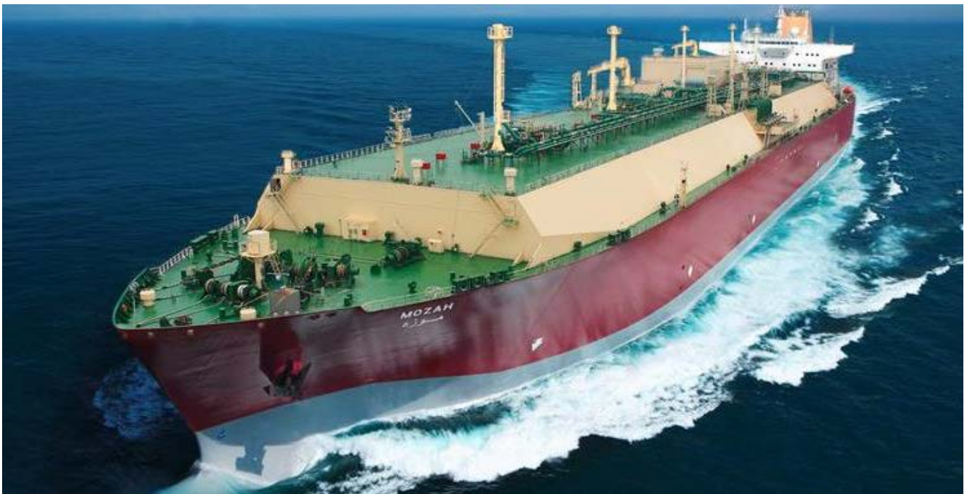
Buque tanque Mozah (de tamaño Q-max y tipología prismática). (Fuente: Qatargas).
