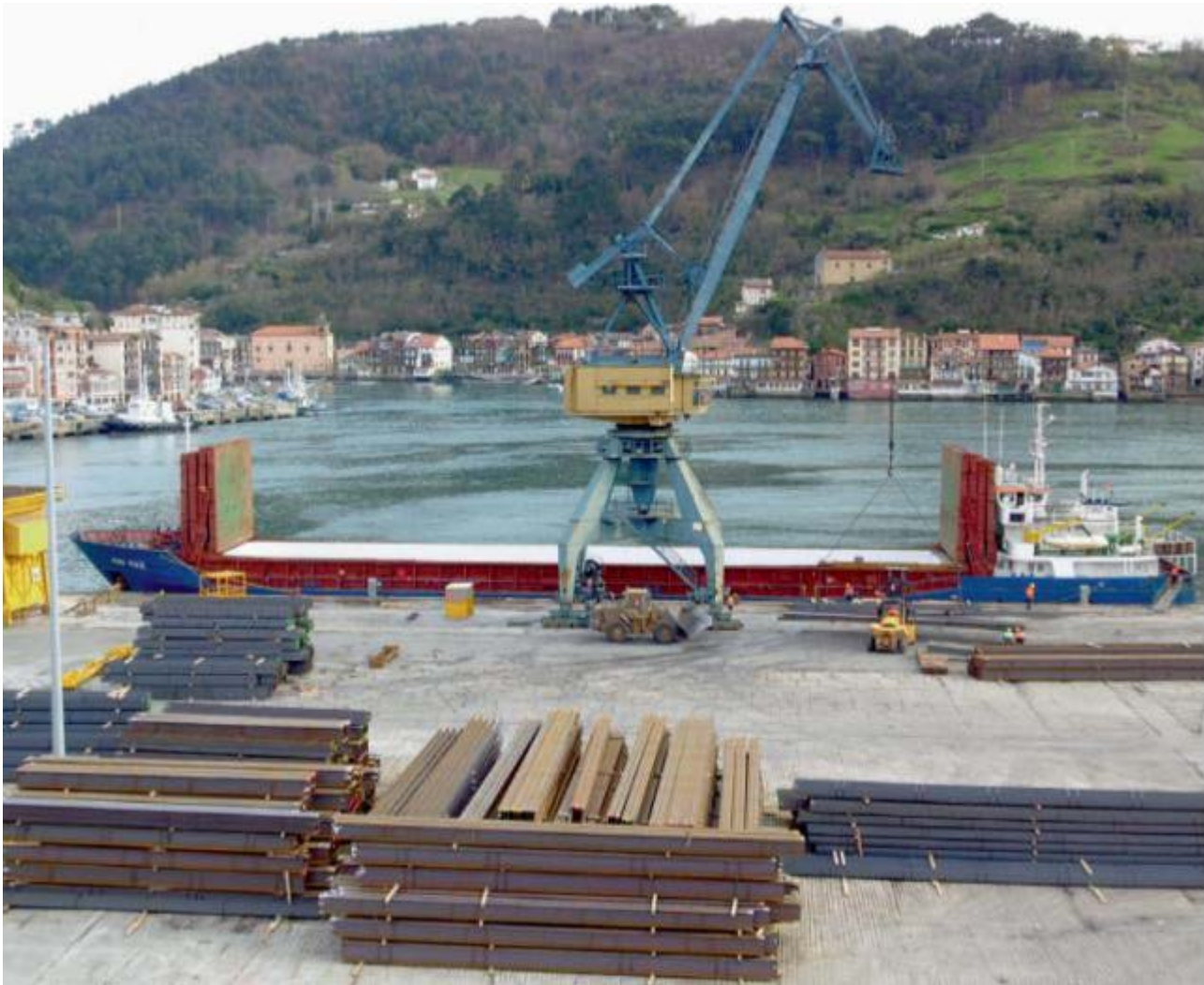
Descarga de perfiles laminados en terminal multipropósito en el puerto de Pasaia. (Fuente: Autoridad Portuaria de Pasaia).
