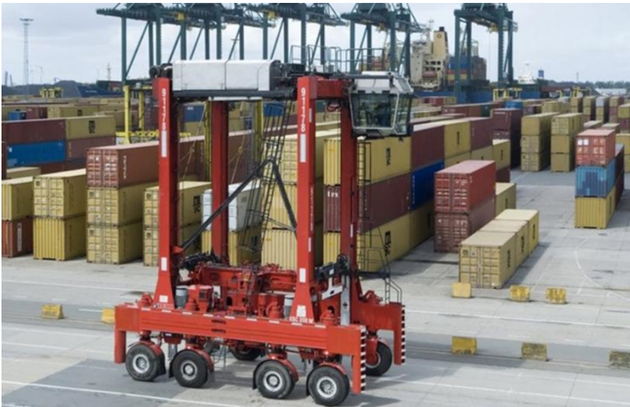
Sistema de almacenamiento mediante carretillas pórtico. (Fuente: Liebherr)
