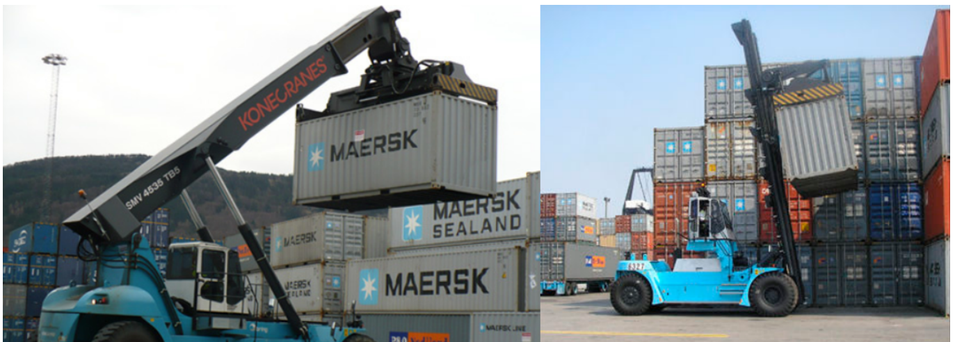
Recah stacker (izquierda) y carretillas frontales (derecha). (Fuente: Konecranes)
