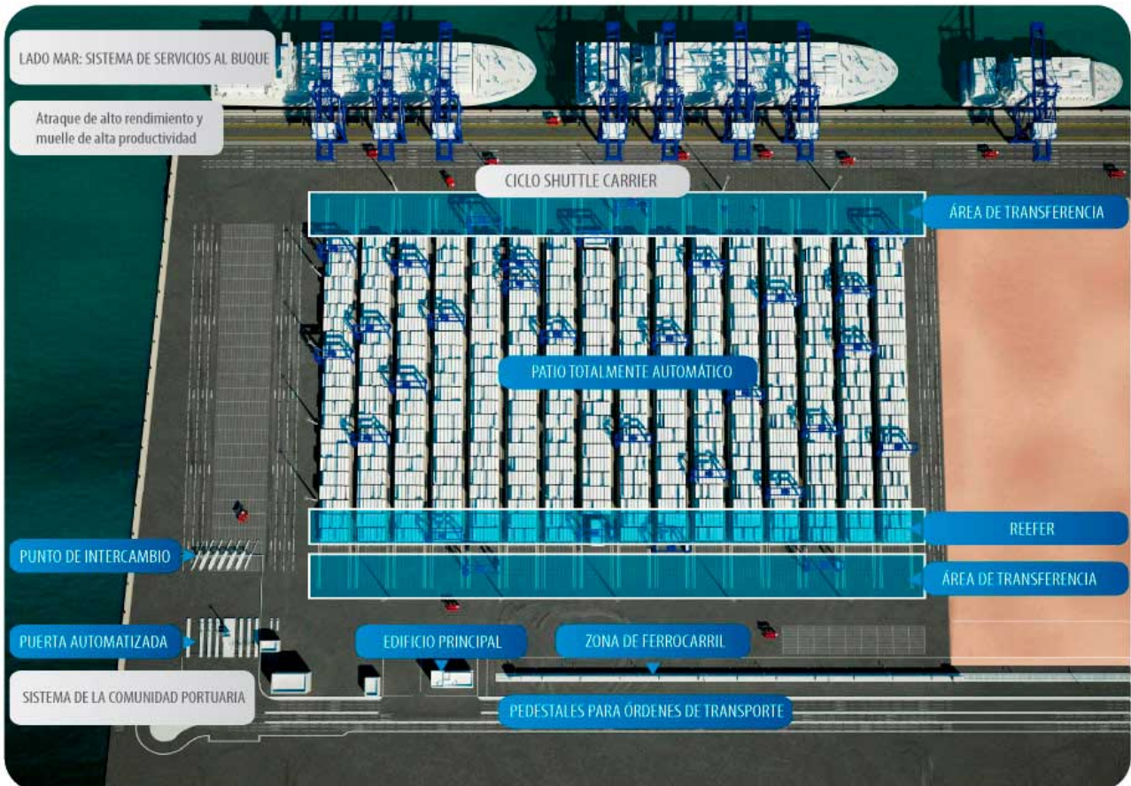
Esquema de la terminal semiautomatizada del Puerto de Algeciras. (Fuente: TTI Algeciras)
