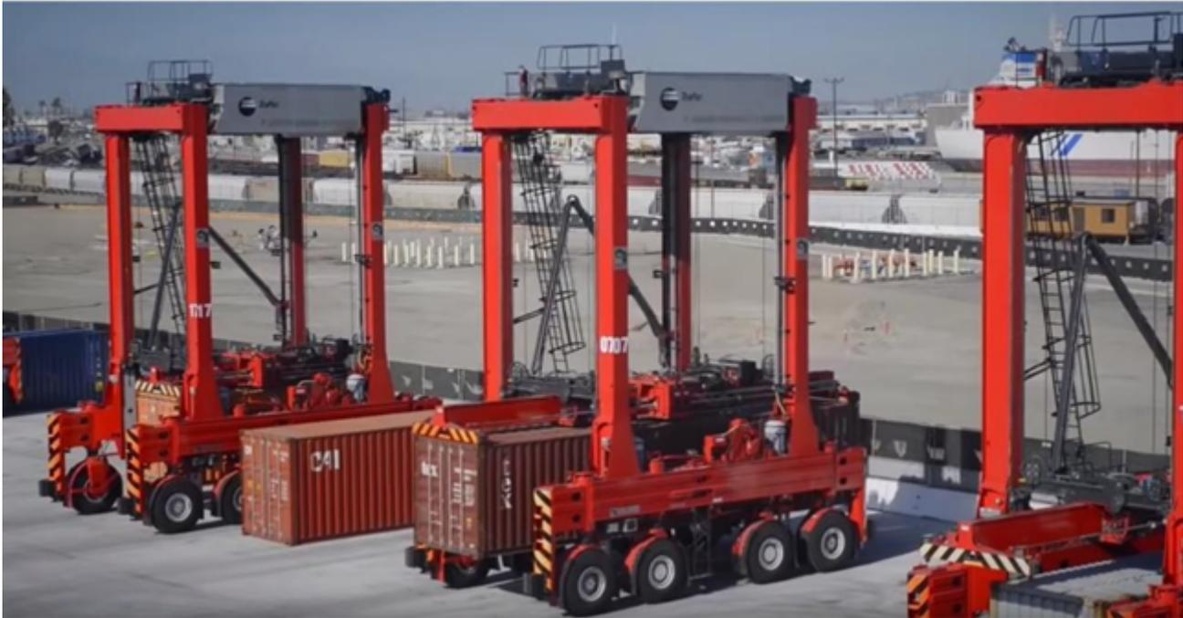
*ALV o Automatic Shuttle Carrier (Fuente: Kalmar)*
