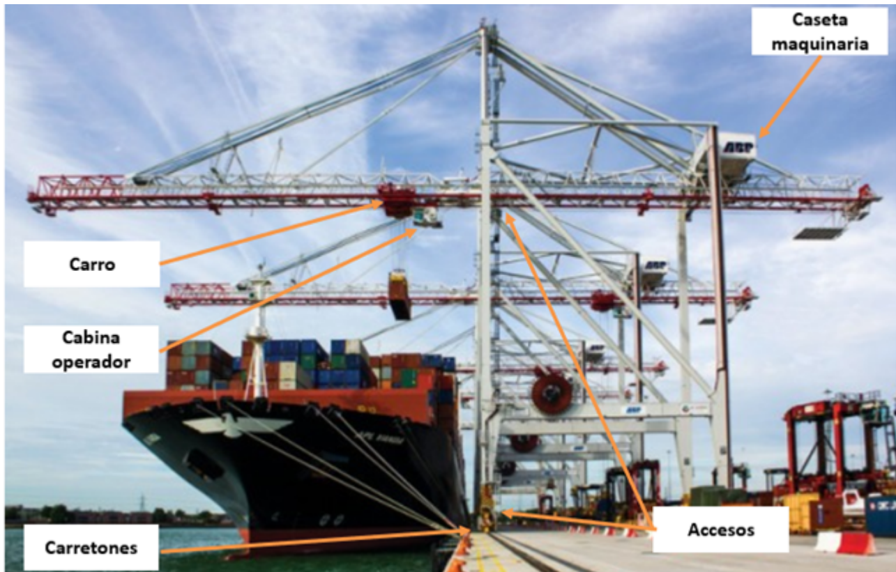
Partes de una grúa pórtico (Ship to Shore). (Fuente: J. L. Estrada)
