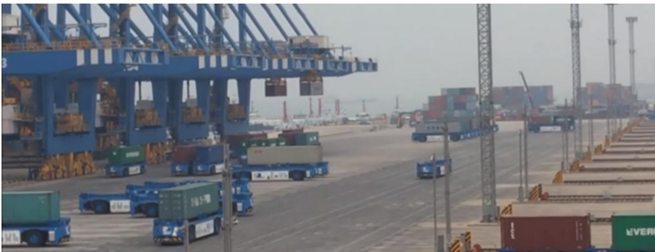
Tráfico de AGV en el Puerto de Qingdao. (Fuente: Port of Qingdao)
