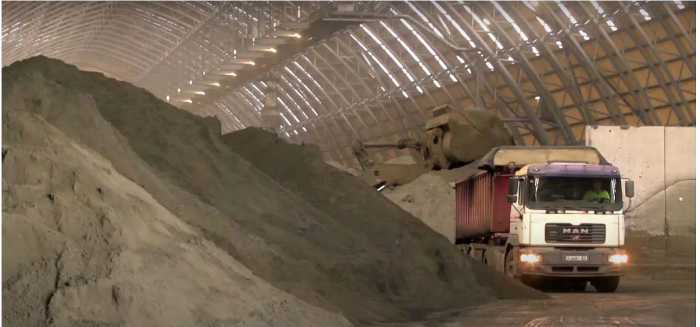
Apilado de concentrado de cobre en almacén cubierto en Impala Terminal. Puerto de Huelva. (Fuente: Autoridad Portuaria de Huelva).
