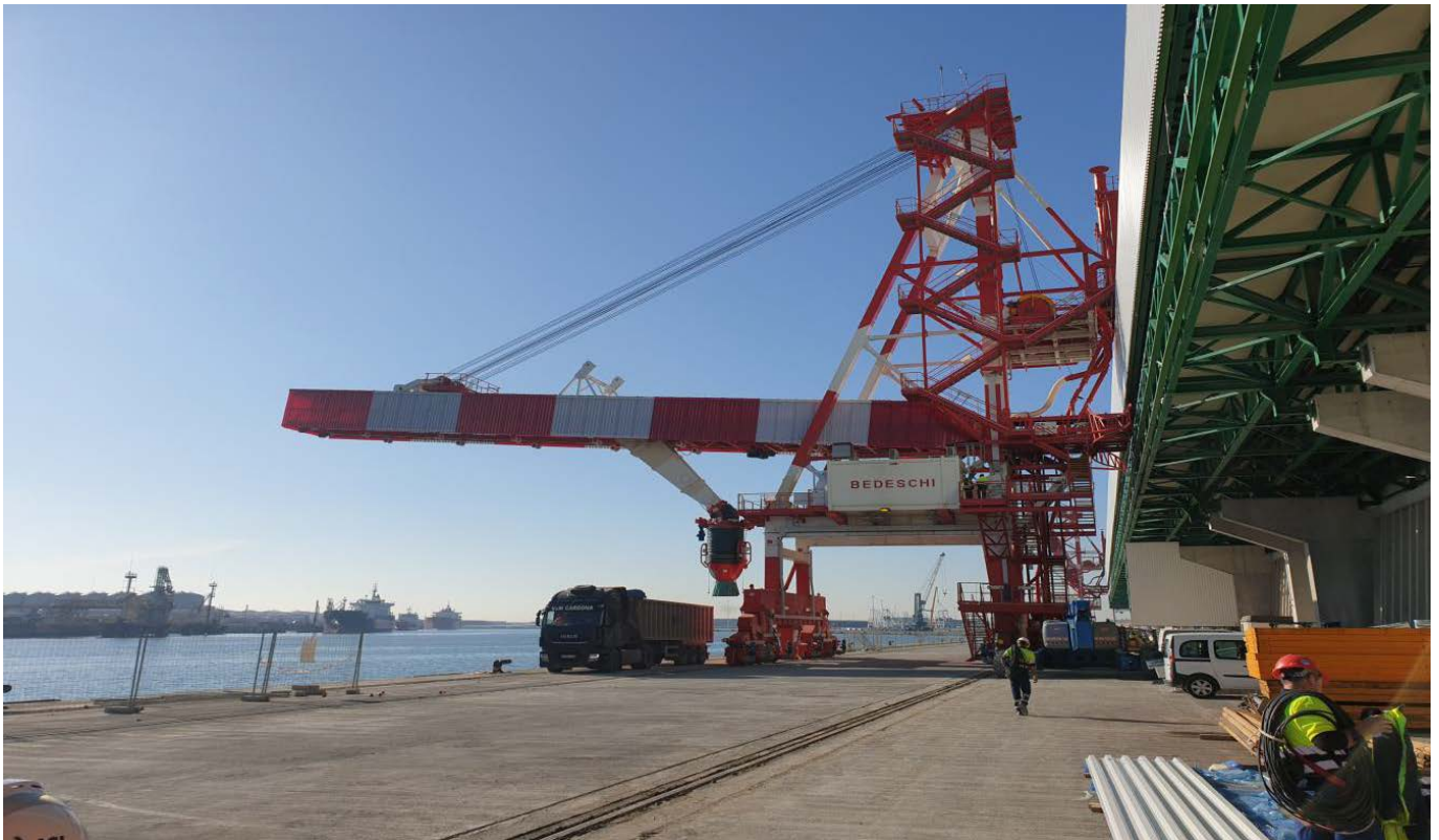
Cargador de buque continuo en la terminal ICL Iberia. Puerto de Barcelona. (Fuente: ICL Iberia).
