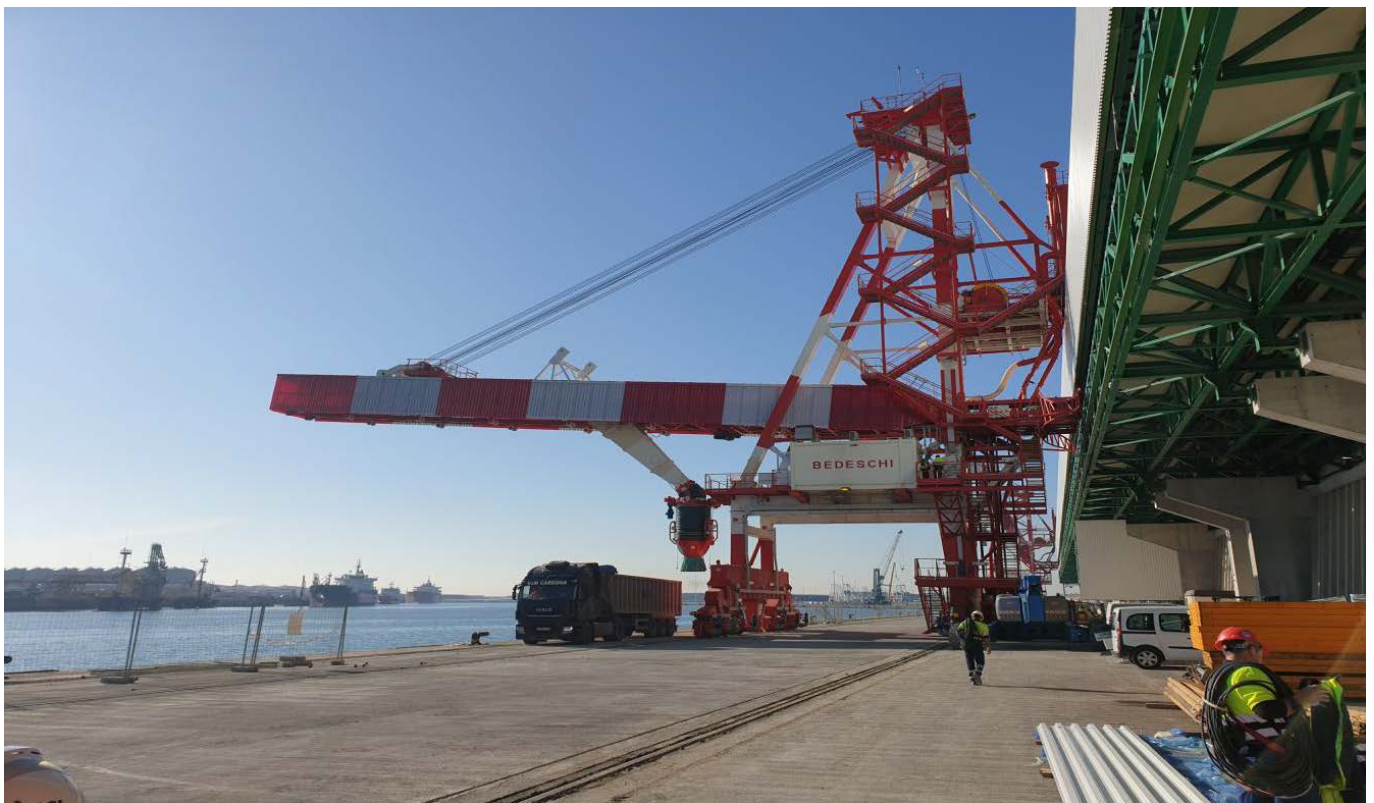
Cargador de buque continuo en la terminal ICL Iberia. Puerto de Barcelona. (Fuente: ICL
