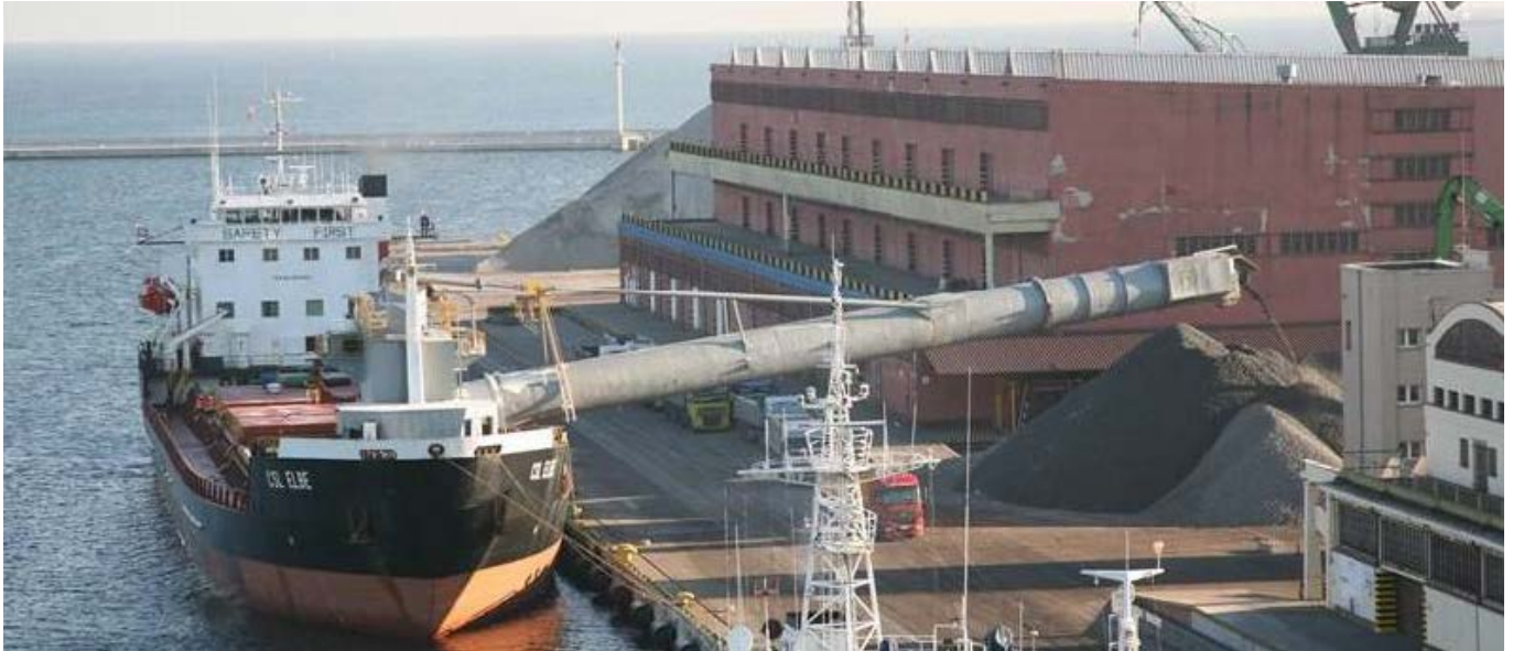
Buque CSL Elbe autodescargante. (Fuente: Marinetráfico).
