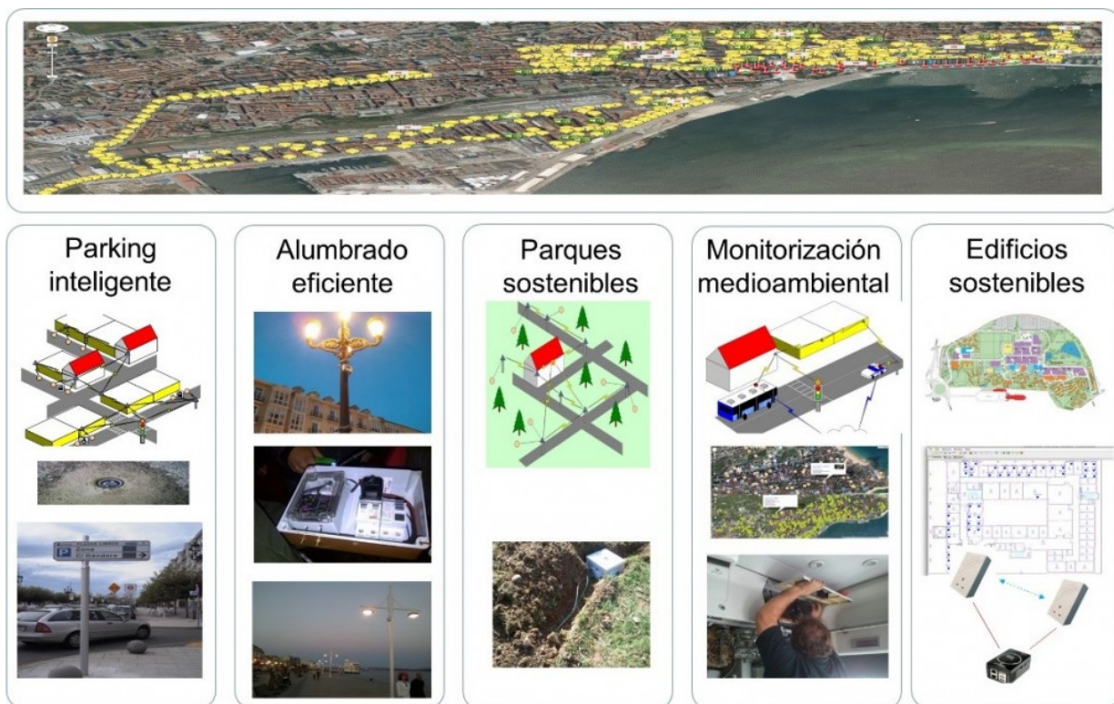
Despliegue de sensores dando soporte a diferentes verticales de servicio. (Fuente FP7-ICT-2009-5 257992 Proyecto SmartSantander)
