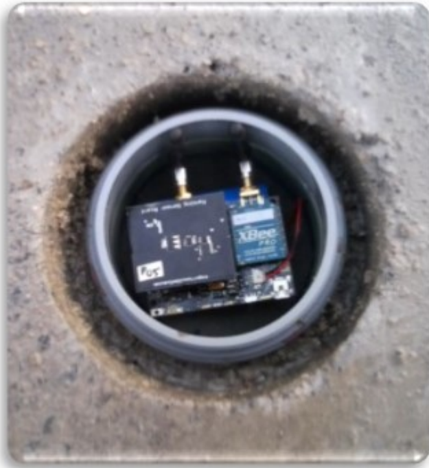
Sensor de aparcamiento. (Fuente: Universidad de Cantabria)
