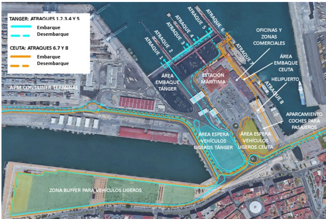
Terminal de pasajeros (ferries) con atraques diferenciados por destinos (Ceuta y Tánger) en el puerto Bahía de Algeciras. Estación marítima y pasarelas elevadas. (Fuente: J.L. Estrada).
