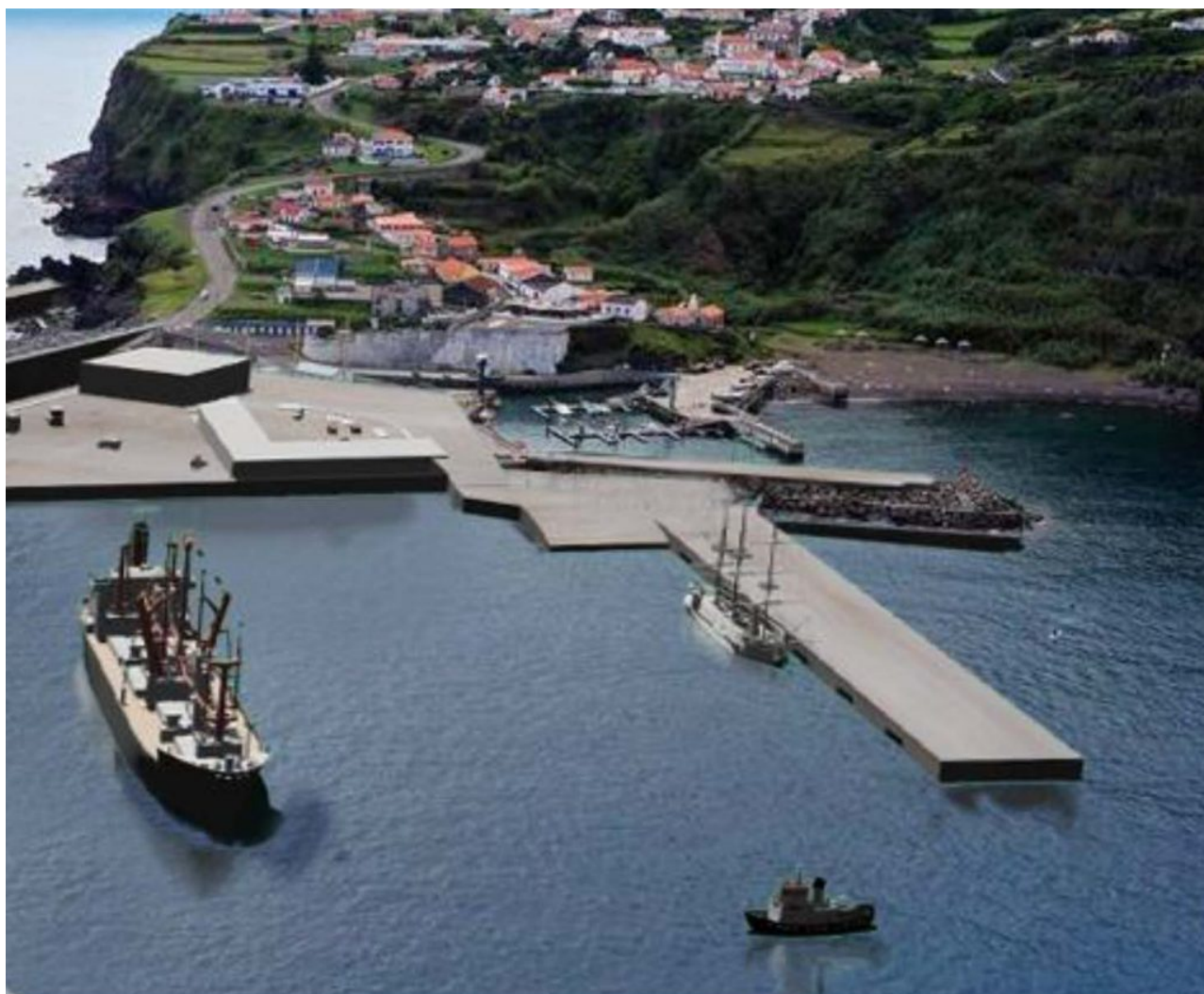
Foto-montagem com a ponte-cais e nova rampa ro-ro aderente. (© Portos dos Açores S.A.).
