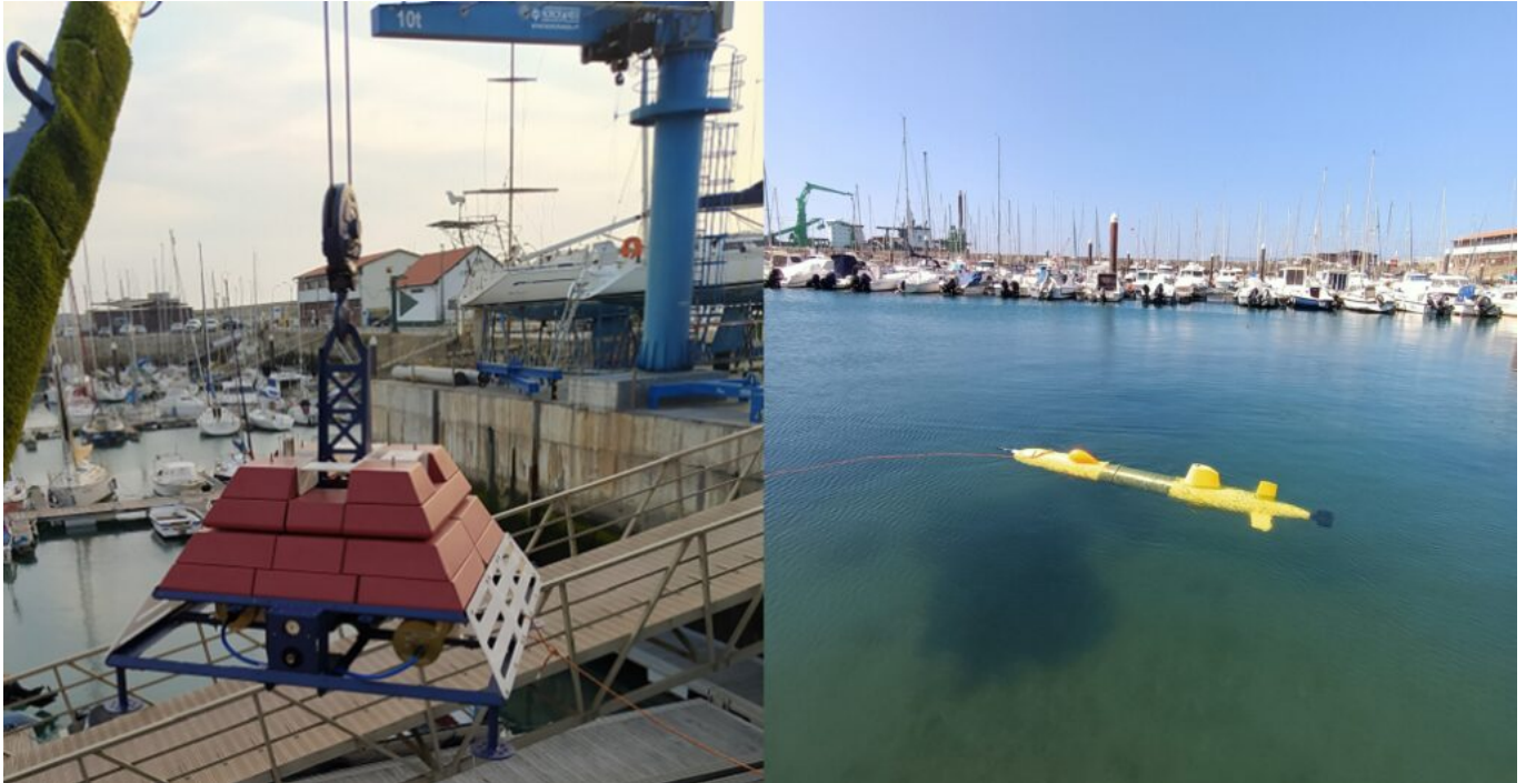
Atlantis (Lander) e Torpedo (AUV) em cenário de testes na Zona Livre Tecnológica de Matosinhos. (Fonte: CEiiA).
