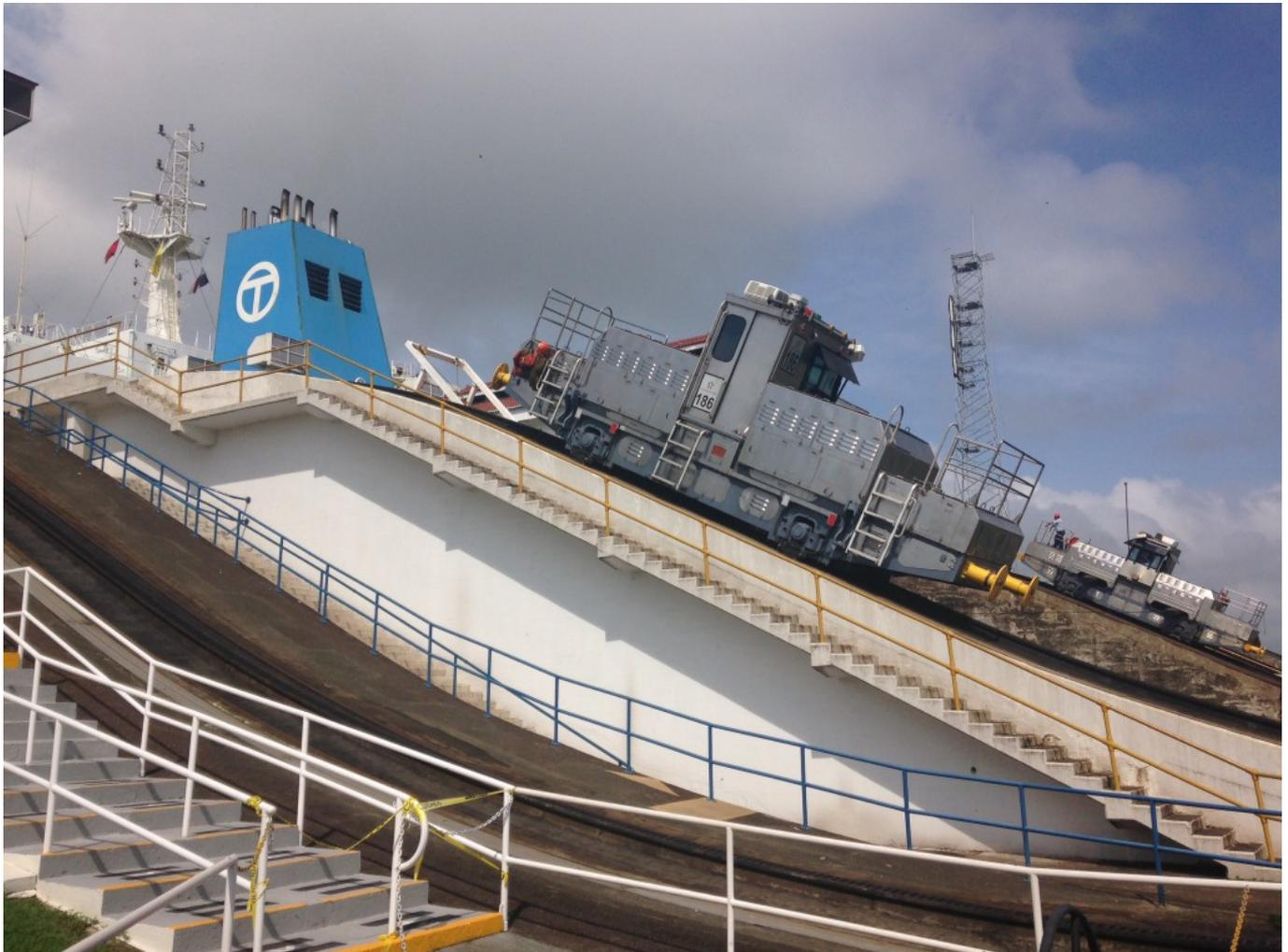
*Locomotoras remolcadoras en las esclusas de Gatún.*
