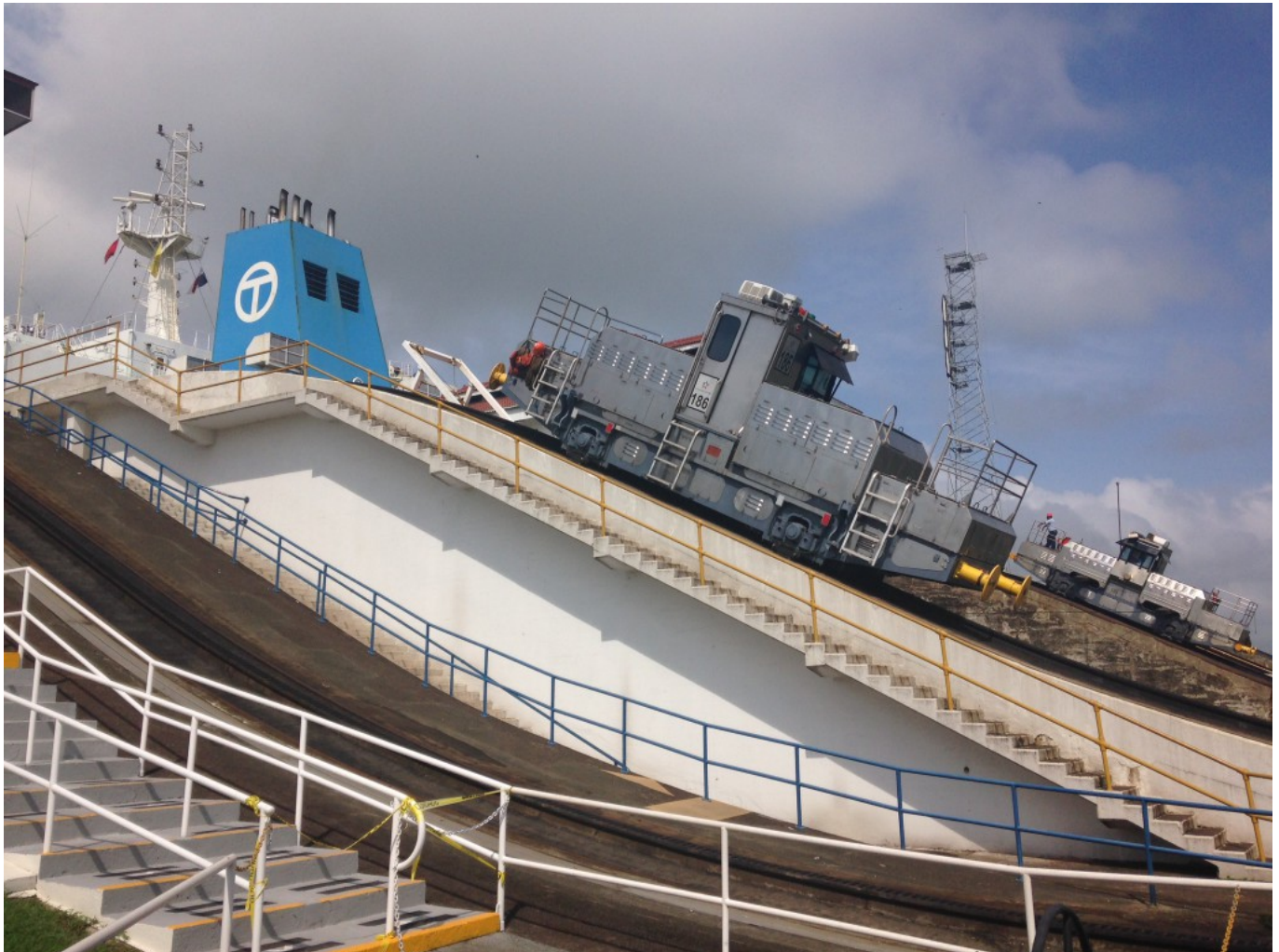
Locomotoras remolcadoras en las esclusas de Gatún.
