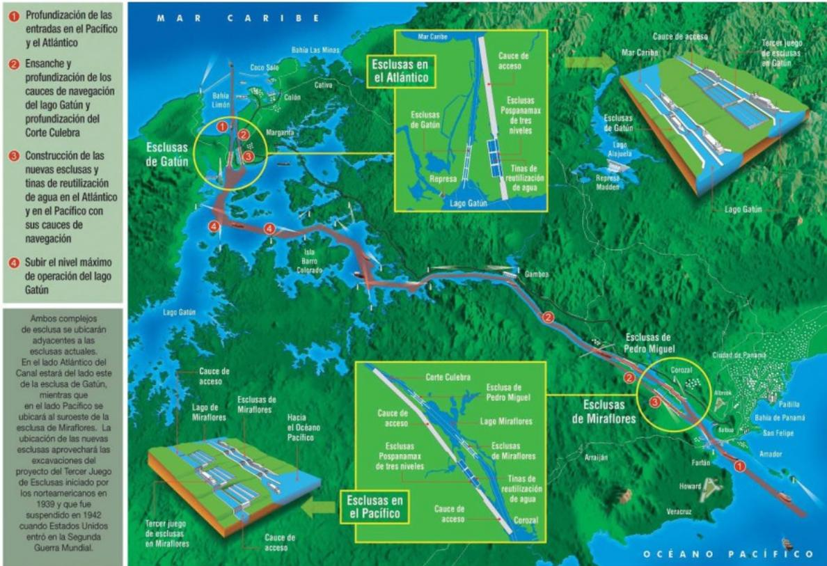
Componentes del Proyecto de Ampliación del Canal de Panamá.
