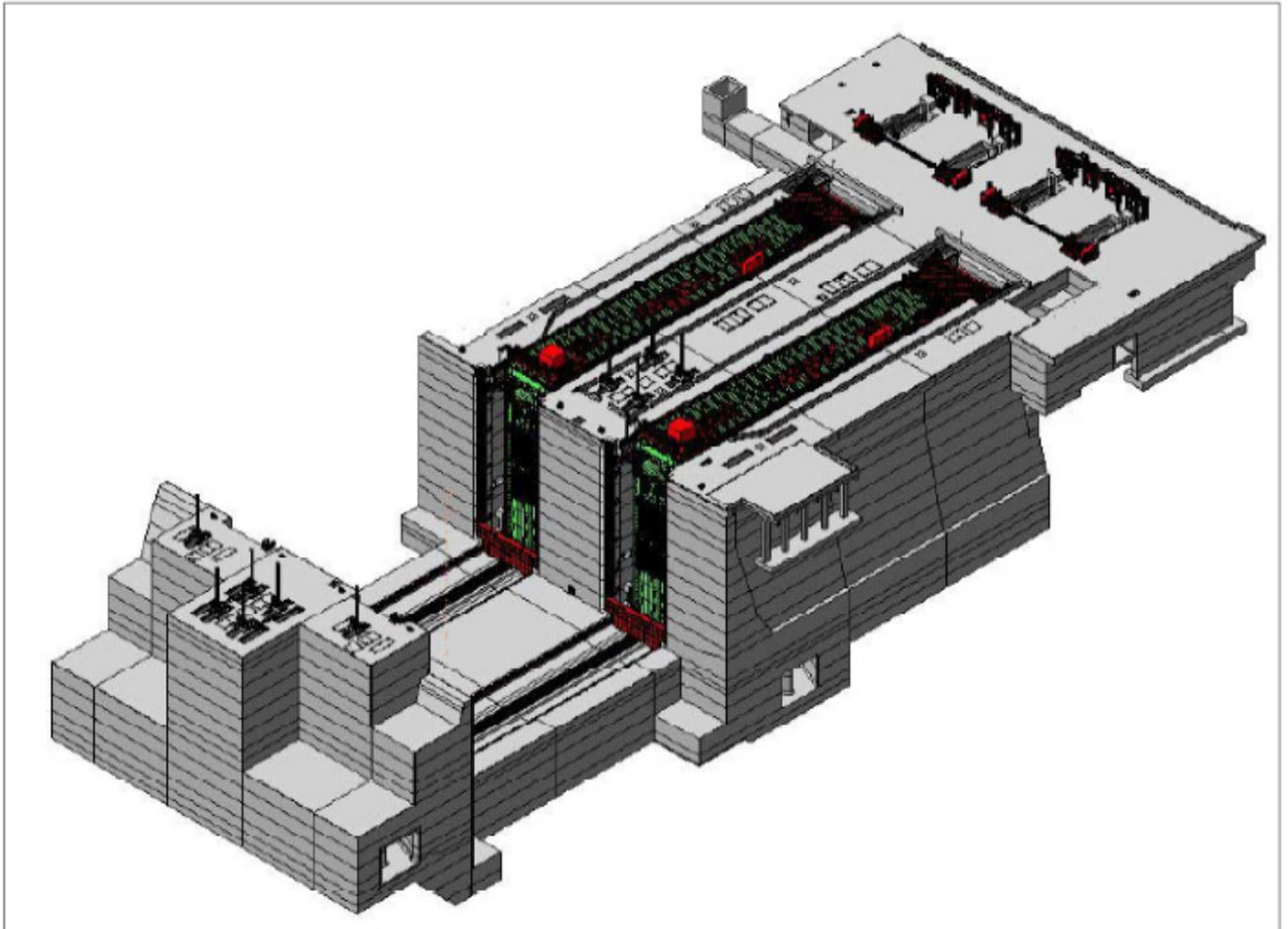
*Los alojamientos de las compuertas rodantes permiten la reparación de las mismas como si fuera en un dique seco.*
