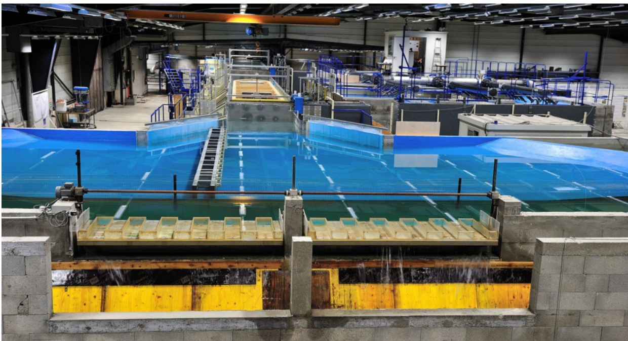
Modelo a escala fabricado en el laboratorio hidráulico de la Compañía Nacional del Ródano (CNR).
