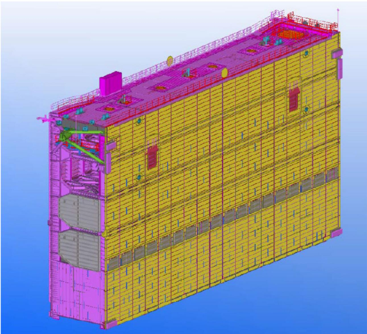
*La estructura de las compuertas es muy compleja por el compromiso del diseño entre la resistencia a la fatiga, que exige rigidez, y la resistencia al sismo, que exige flexibilidad.*
